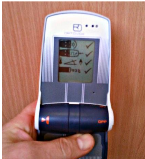
Novejše naprave ob vklopu samostojno opravijo test – self test
